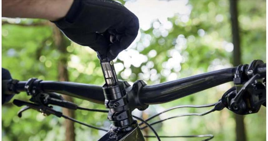
La multiherramienta incorpora una amplia variedad de puntas Allen, un destornillador, un tronchacadenas y espacio para eslabones rápidos.
